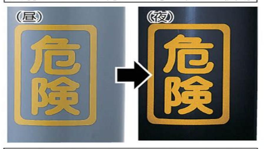
反射性能はJIS Z 9117の試験方法による (観測角0.2°入射角5°)
