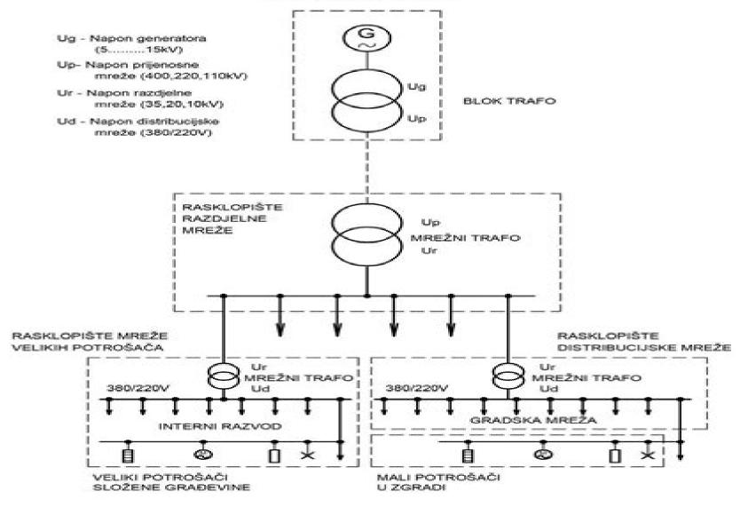
Slika 1.1: Opći shematski prikaz elektroenergetskog sustava
